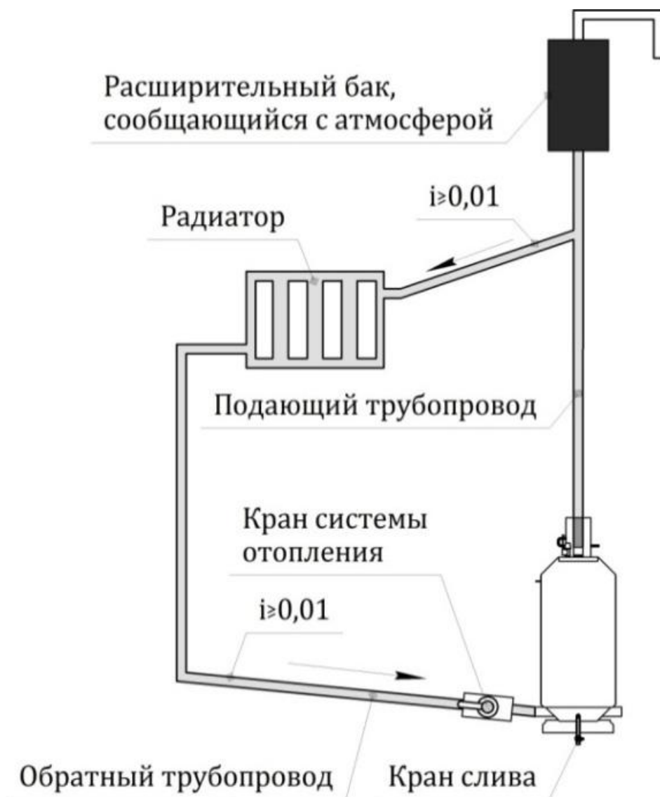
Рисунок 8 – Схема открытой системы отопления с естественной циркуляцией
